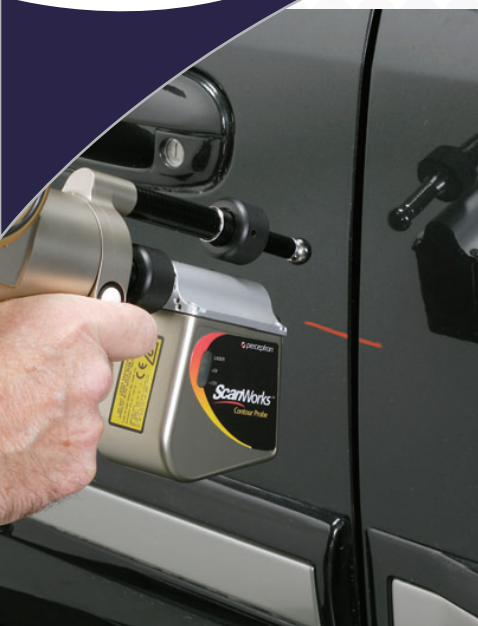
生产车辆的扫描，用于质量检验
